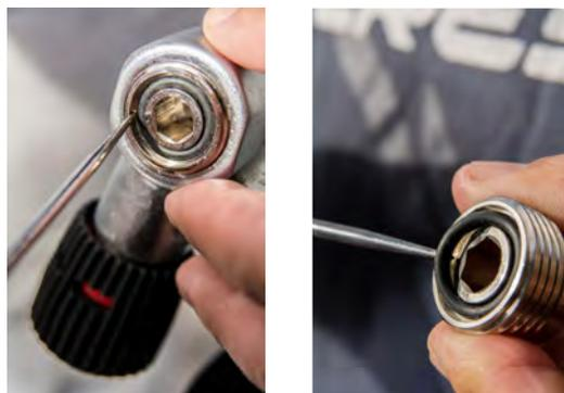
**Si la junta tórica está deteriorada, o no hay, al abrir la grifería se escapa el aire.** Entonces deberemos cerrarla, quitar el regulador y sustituir la junta por una nueva. Las juntas tóricas (o un núcleo completo) son repuestos que es imprescindible llevar.
