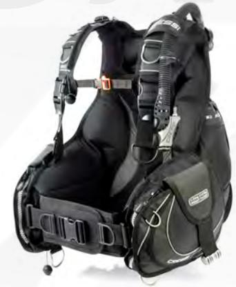
A la altura del hombro se encuentra la tráquea de inflado y desinflado, que acaba en una boquilla que permite inflarlo con la boca cuando simultáneamente se aprieta el botón de apertura.
