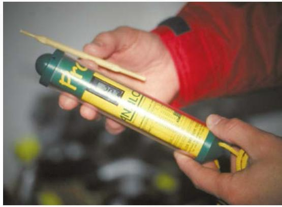
Figura 20. Otro tipo de oxímetro. Este tiene todos los elementos integrados en el cuerpo cilíndrico. La varilla se utiliza para actuar sobre el tornillo de calibración
