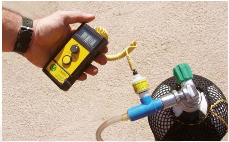
Figura 19. Las proporciones en las mezclas no salen siempre exactas. Elementos del Oxímetro: A Sensor, B Interpretador, C captador .
